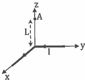
سیمی به طول  $L$  را از وسط  $90^\circ$  درجه خم می‌کنیم و مطابق شکل روبرو طوری قرار می‌دهیم که بازوهای آن روی محور  $x$  و  $y$  باشد. اگر این قطعه سیم، بخشی از مداری باشد که جریان  $I$  از آن عبور می‌کند، اندازه میدان مغناطیسی ناشی از این قطعه در نقطه  $A$  که در ارتفاع  $L$  از صفحه  $xy$  واقع بر محور  $z$  قرار دارد، کدام گزینه است؟
